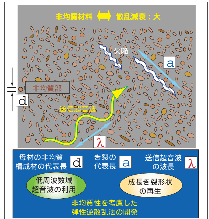
図-5 非均質体中の欠陥と送信超音波
