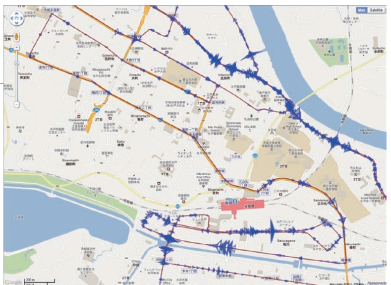
図6 水戸駅周辺での路面段差状況(観測日:7/9)
