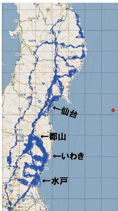
図4 東北地方における路面段差分布状況 (観測日: 4/2 ~ 5/8)
