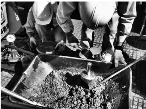
写真3 スランブ試験とエア-の計測
