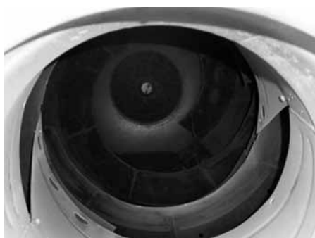
写真5 アジテータ車のドラム内部の様子。外側にあるのがミキシングフレーム
