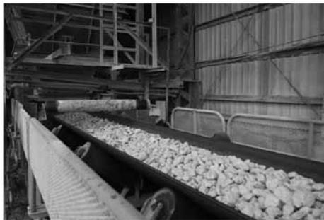
写真4 ベルトコンベヤーで運ばれる石灰石製品
