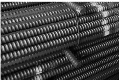
写真3 一目で太さと強度がわかるよう色付けされて束ねられた鉄筋
