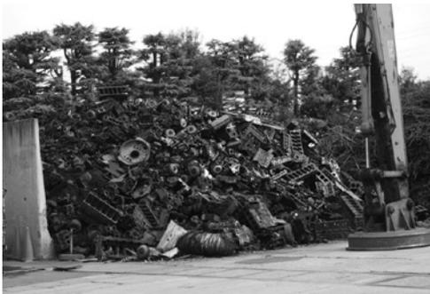
写真2 鉄筋の原料である鉄スクラップを種類別に分別
