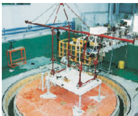
写真-2 1/15縮尺模型振動実験（栈橋とガントリークレーンの連成解析へ）
