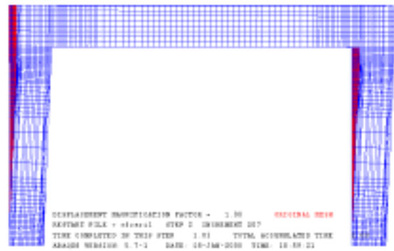
図 7. プッシュオーバー解析図 (Case1) (強制水平変位=10cm)
