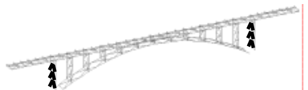
図-4 座屈拘束ブレース設置箇所
