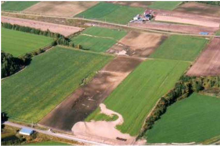
(2003年十勝沖地震 端野町協和地区) Kcflの大規模な液状化・農地変状
