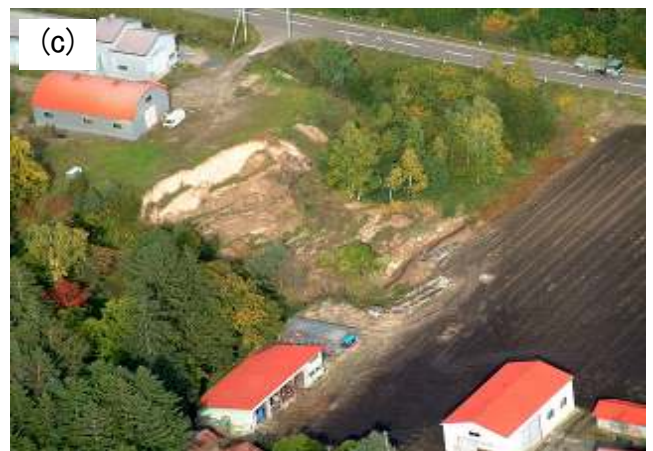
写真－2 北見市の火山灰地盤の大規模液状化 (a) 端野地区の農地面に噴出した泥流化火山灰 (b) 出現した多数の噴砂孔 (c) 広郷地区
