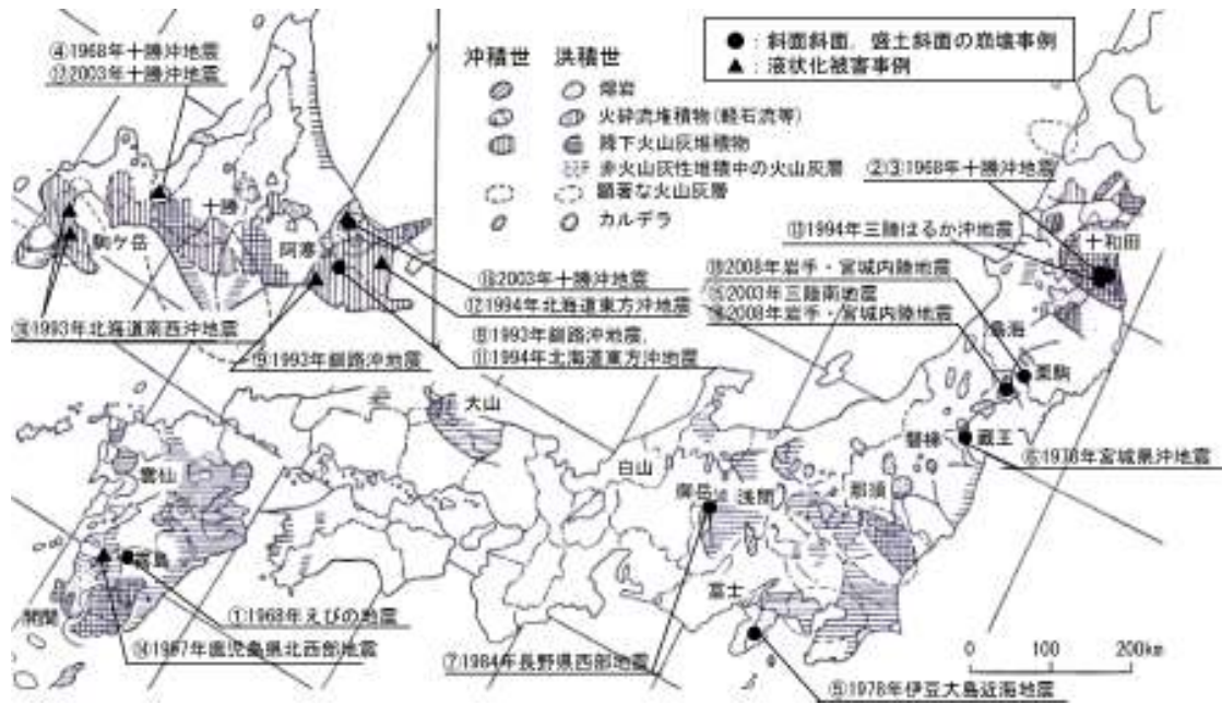
図-9 地震による我が国の火山灰地盤の崩壊事例
