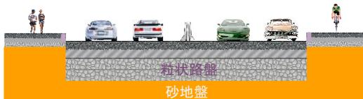
砂地盤の液状化による舗装下の空洞発生メカニズム(2/5)
