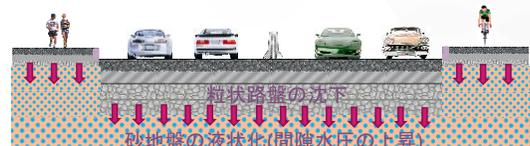
砂地盤の液状化による舗装下の空洞発生メカニズム(3/5)
