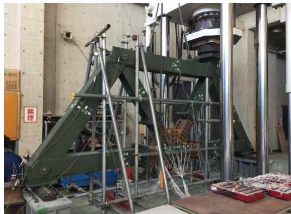
トラス格点腐食部補修実験
