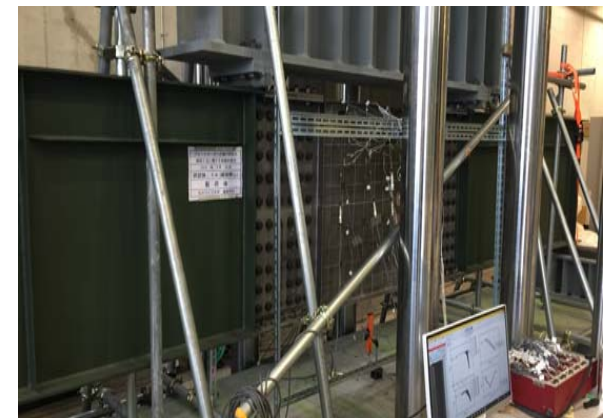
プレートガーダー補強実験
