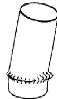
(b) 円形断面鋼製橋脚における変形の集中, 進展に伴う傾斜, 割れ
