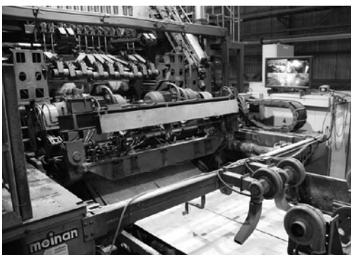
写真2 ロータリーレースによる原木のかつらむき
