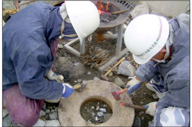
図-11 鍛冶作業2（石割矢尻の製作）
