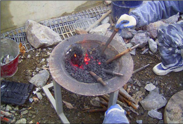
図-10 鍛冶作業1（石割矢尻の製作）
