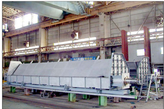
図-17 ゲート組立状況（三菱重工㈱ 横浜製作所）
