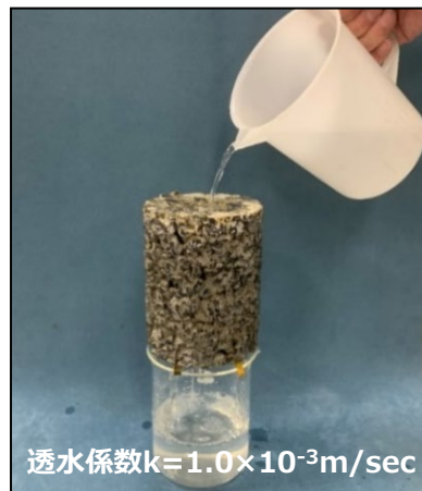
透水性地盤改良体
