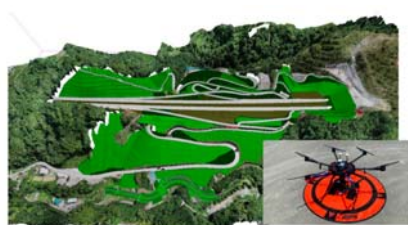
【設計・数量】3次元総合モデル（設計モデル+測量データ）
