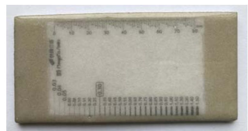
クラックスケールに「クリア」を施工した状況
